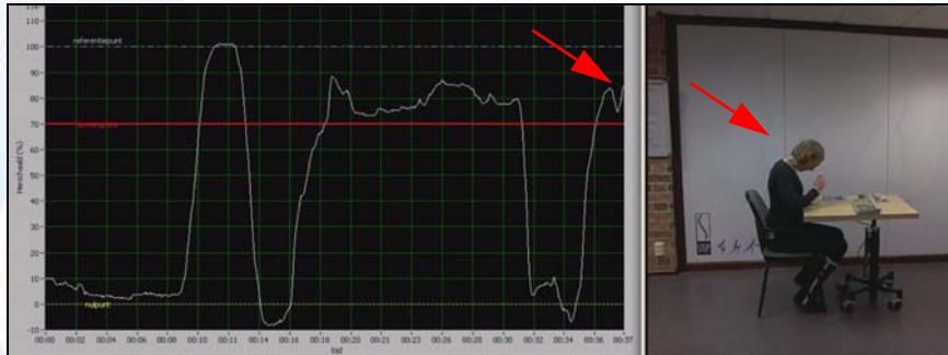
Afb. 2. Nadat de maximale nekbuiging is vastgelegd (witte lijn) worden 5 standaard handelingen verricht. De meting met de BodyGuard laat dan zien hoe de nek beweegt t.o.v. de alarmgrens en de maximale buiging. De alarmgrens (rode lijn) wordt op 70% van de max. buiging ingesteld. In de afb. is te zien dat de nek zich dicht bij de maximale buiging bevindt (rode pijlen) bij het eten van soep.
