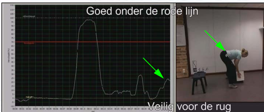
Afb. 3. Vervolgens laat de Instructeur een voorbeeld zien van meting met de BodyGuard bij iemand die dezelfde handelingen verricht met de GHT en maakt hiermee duidelijk hoe je met GHT onder de alarmgrens en ver van de maximale buiging kunt blijven. In de afb. ziet u hoe de rug ver van de maximale buiging en rode lijn blijft bij dezelfde handeling als in afb. 2 (groene pijlen).
